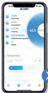
\* Das Smart BMS (Smart Battery Management System) ermöglicht über integriertes Bluetooth 4.0 die Überwachung, den Schutz und die Verwaltung von Betriebsparametern der Batterien, um ihre Leistung zu optimieren, ihre Lebensdauer zu verlängern und die sichere Nutzung und Verwaltung über Ihr Smartphone oder Tablet zu gewährleisten.
